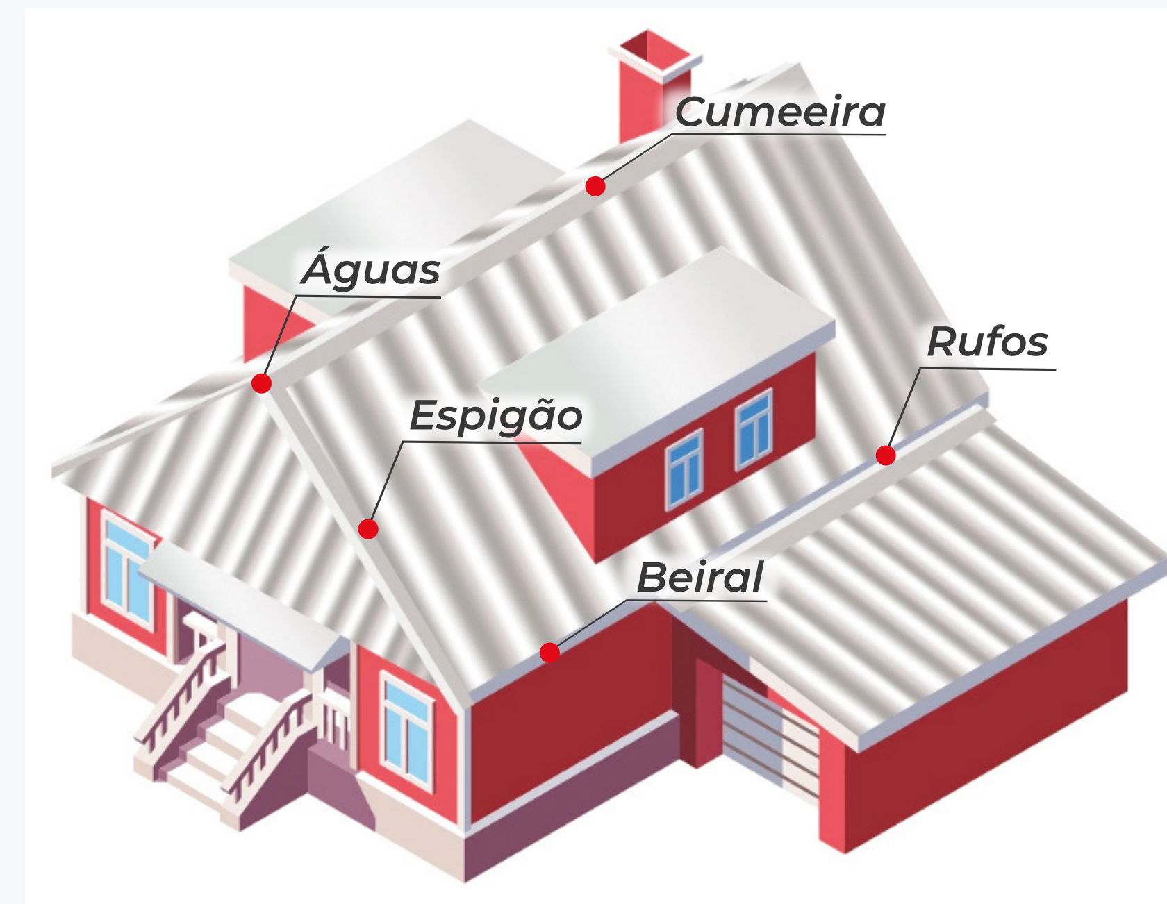
Imagem: Cobertura em telhado
